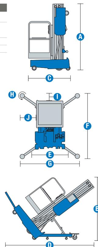
(1) Altura de trabajo = Altura de la plataforma + 2 m.
